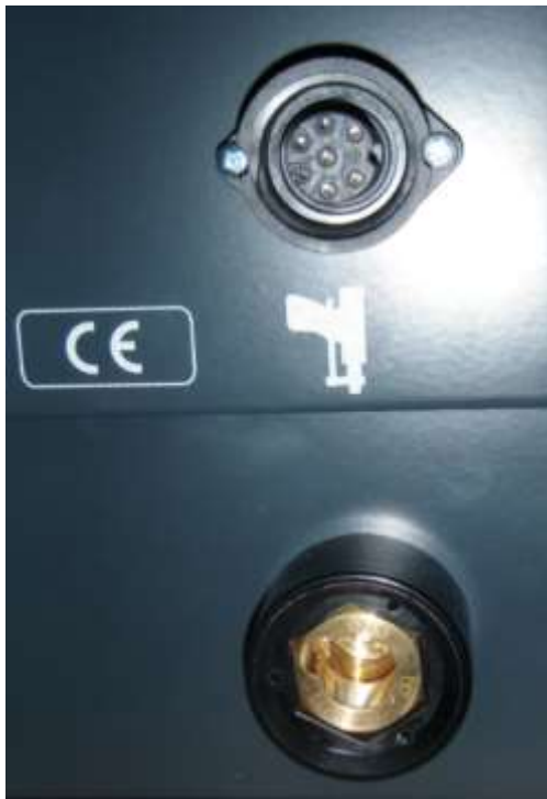
Obrázek 8: Zapojení svařovací pistole
