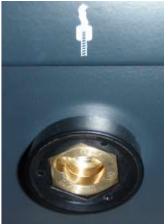
Obrázek 6: Připojení zemnicí kabelace
